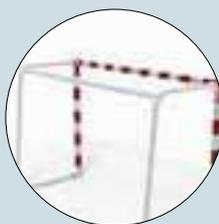
Robustesse de son ossature arrière. Arceaux + barres de renfort haute et basse en 50x50mm.
